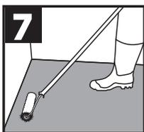
Termine la aplicación usando un jalador ajustable para morteros, dentro del tiempo de trabajo. Use zapatos con suela de clavos para pisar en el mortero fresco.
