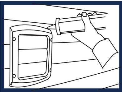
3. Fije la tapa a la pared mediante tornillos o colocando silicón por el contorno de la tapa.
