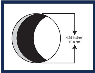
1. Abra en la pared un agujero de 4 1/4" de diámetro o inserte en la ventana una placa con un agujero de 4 1/4" de diámetro.
